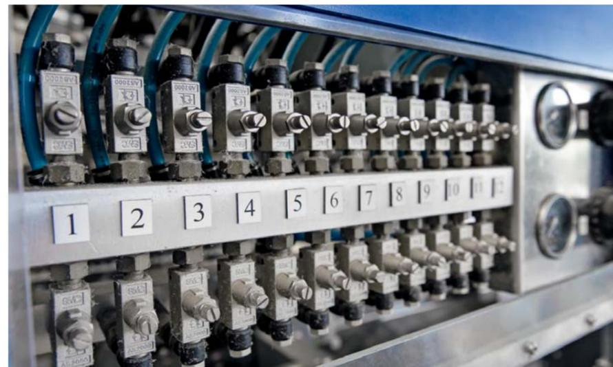
Control del aire auxiliar para el cabezal del tubo.
