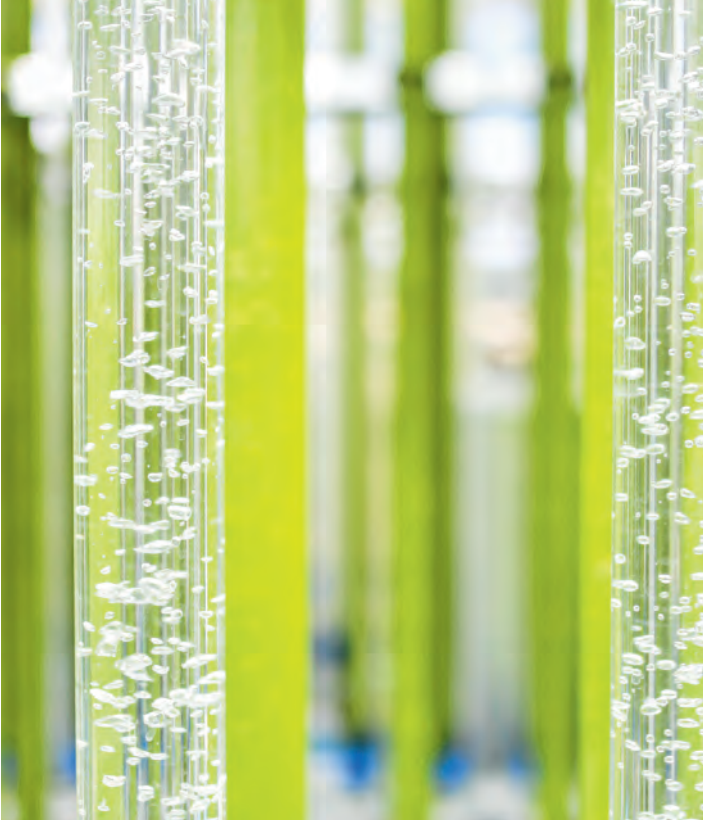
Los principales componentes de la planta son las largas filas de tubos de vidrio interconectados de seis metros de altura.
