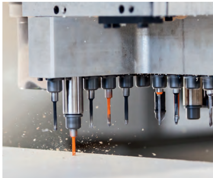
También se necesita aire comprimido para taladrar las piezas de madera.
